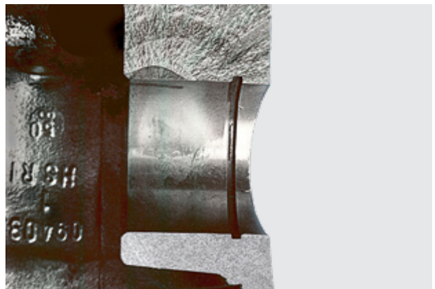
Fig. 3: Corte transversal de um cubo de pino de pistão
