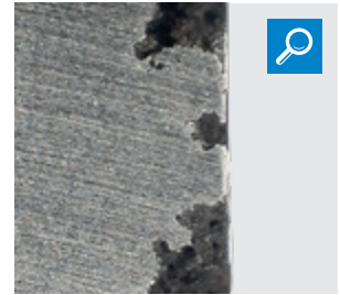
Fig. 3: Corte transversal da camisa de cilindro
